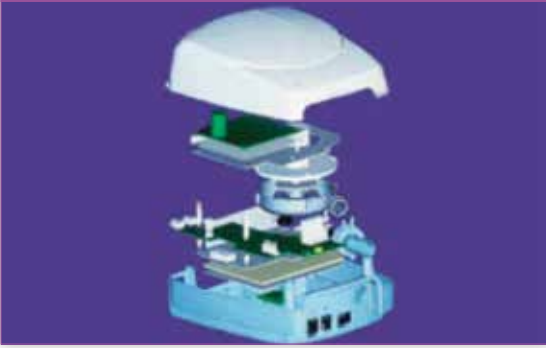
Resim 1. CPAP Cihazının Pozitif Basınç Veren Motor Ünitesi.
