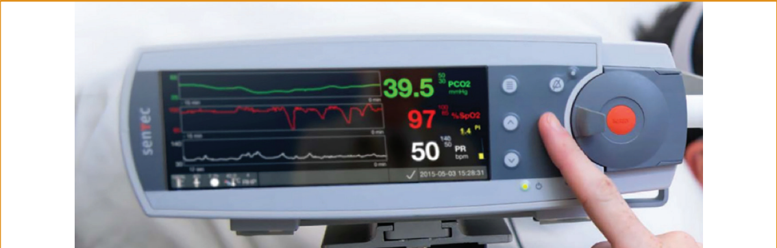
Şekil 5. Transkutanöz karbondioksit ölçüm cihazı (SenTec V-Sign™ System. www.sentec.com/int/products/sentec-v-signtm-system ).
